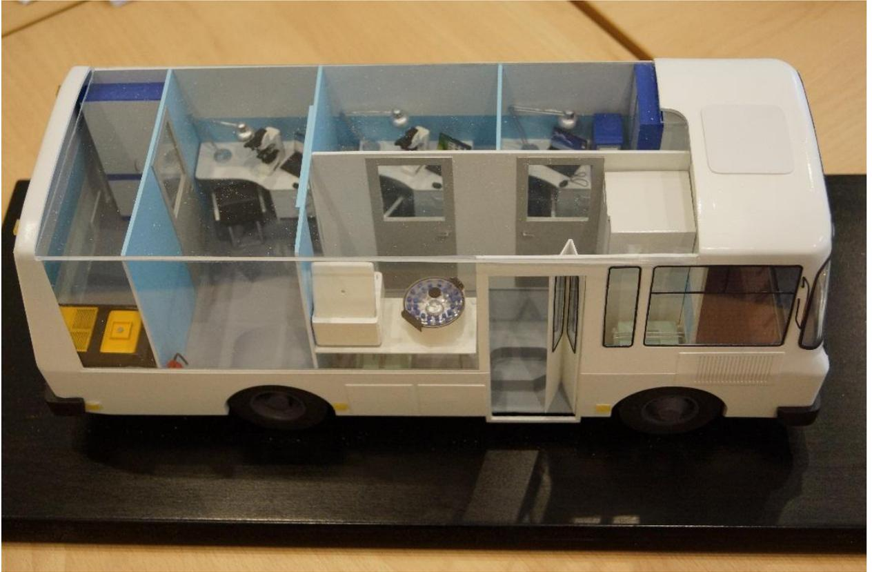
**Рисунок 5.6. 3D модель мобильной паразитологической лаборатории**
