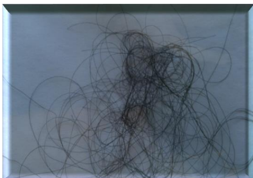
Рисунок 2 – Волокнистый и гранулированный NiTi.
