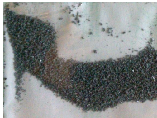
Рисунок 2 – Волокнистый и гранулированный NiTi.
