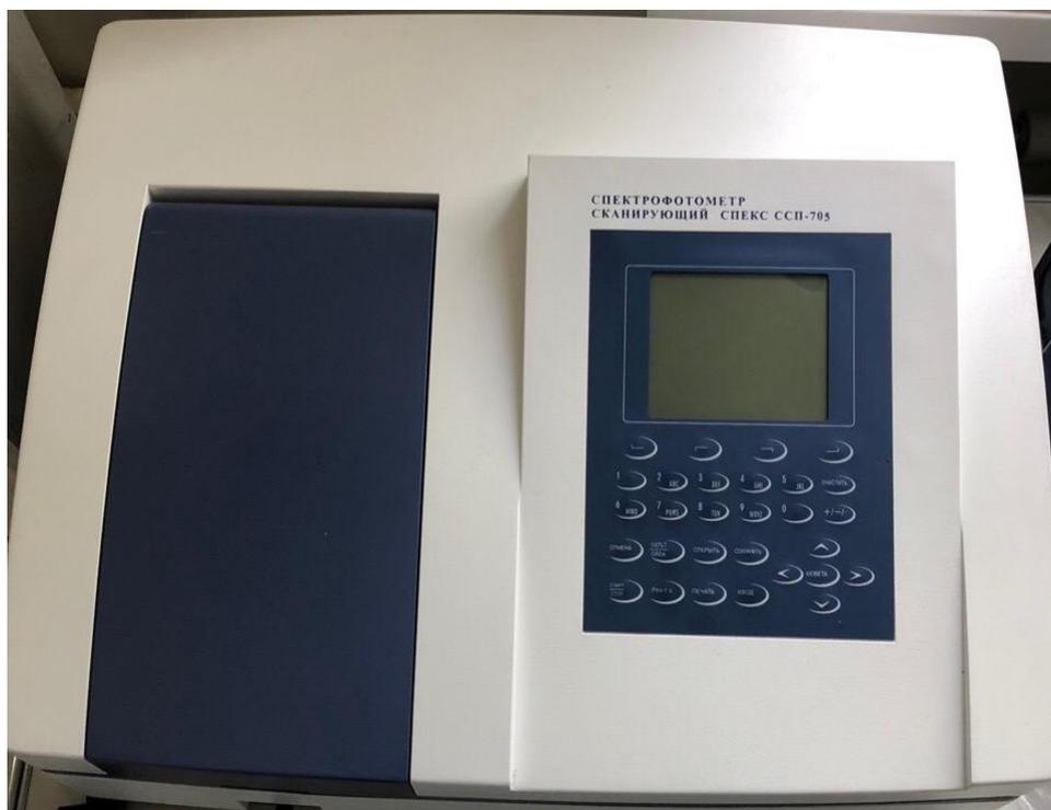
Рисунок 2 - Спектрофотометр, сканирующий СПЕКС ССП-765
