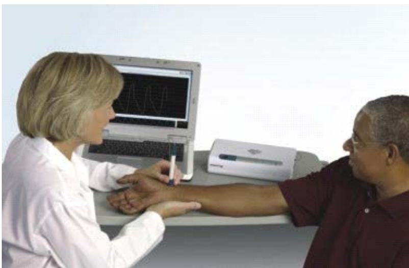
**Рисунок 8 - Методика измерения амплитуды пульсовой волны на предплечье с помощью прибора SphygmoCor**
