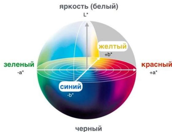
**Рисунок 5. Оси светового пространства со значениями  $a$ ,  $b$ ,  $L$**
