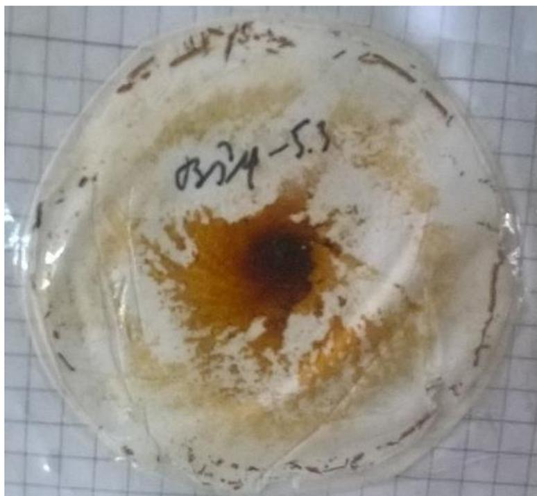
**Рисунок 6.** Осадок, образующийся при ультраfiltrации фуллерена на мембране из регенерированной целлюлозы
