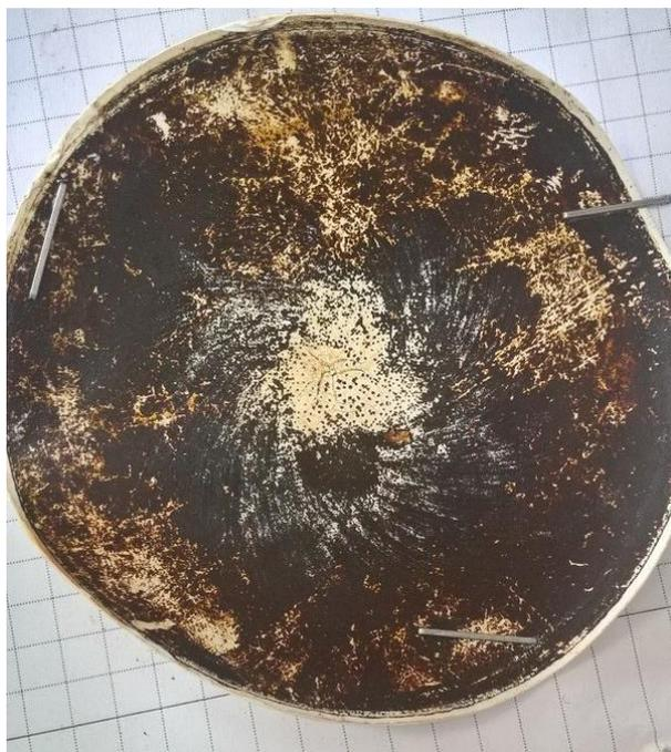
**Рисунок 5.** Нересуспендируемый осадок фуллерена  $C_{60}$  на поверхности полиалкилнитриловой мембраны
