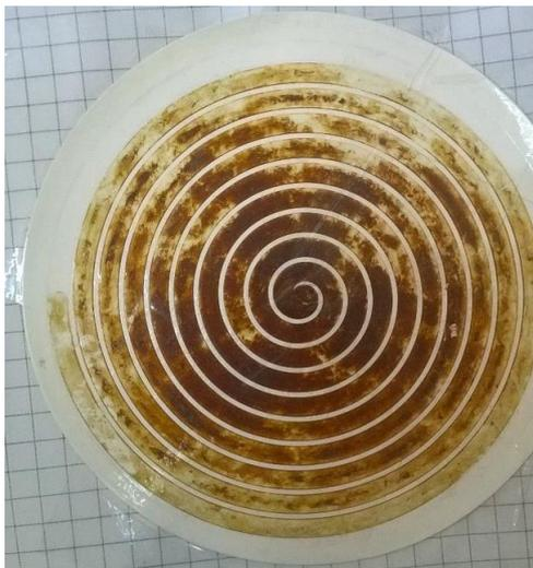
**Рисунок 9.** Осадок, образованный при тангенциальной ультрафильтрации фуллерена  $C_{60}$  на мембране из полиалкилнитрила
