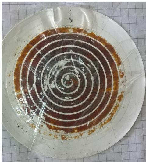
**Рисунок 10.** Осадок, образованный при тангенциальной ультрафильтрации фуллерена  $C_{60}$  на мембране из полисульфона
