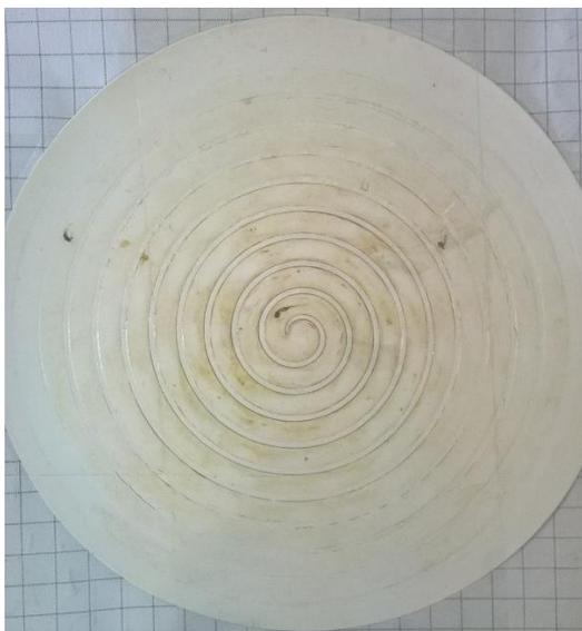
**Рисунок 11.** Осадок, образованный при тангенциальной ультрафильтрации фуллерена С60 на мембране из регенерированной целлюлозы
