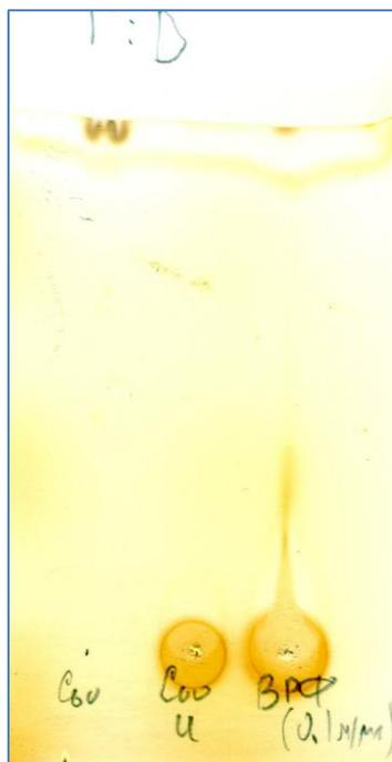
**Рисунок 29.** Результат ТСХ образцов раствора фуллерена в толуоле (слева), дисперсии фуллерена, полученной посредством растворения в ультразвуке (по центру) и дисперсии, полученной методом ультрафильтрации (справа)
