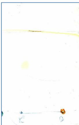
**Рисунок 30.** Результат ТСХ образцов раствора фуллерена в толуоле (слева) и дисперсии, полученной методом ультрафильтрации (справа)
