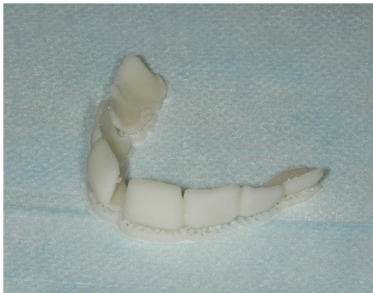
Рисунок 14 - Внешний вид прототипа АТ из ГПК, распечатанный на 3D-принтере
