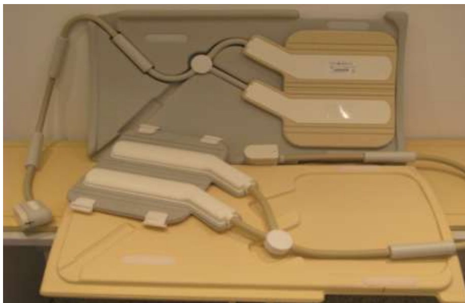
Рисунок 3 — 32-канальные поверхностные катушки, два элемента — верхний (1) и нижний (2), применяемые для исследования органов малого таза при МРТ и МРС.
