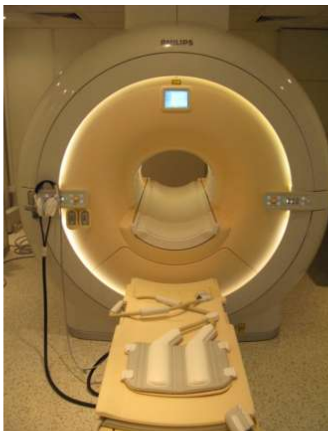
Рисунок 2 — МР-томограф InitialAchieva, фирмы Philips (Нидерланды), с мощностью магнитного поля 3 Тл, с системой ТХ.
