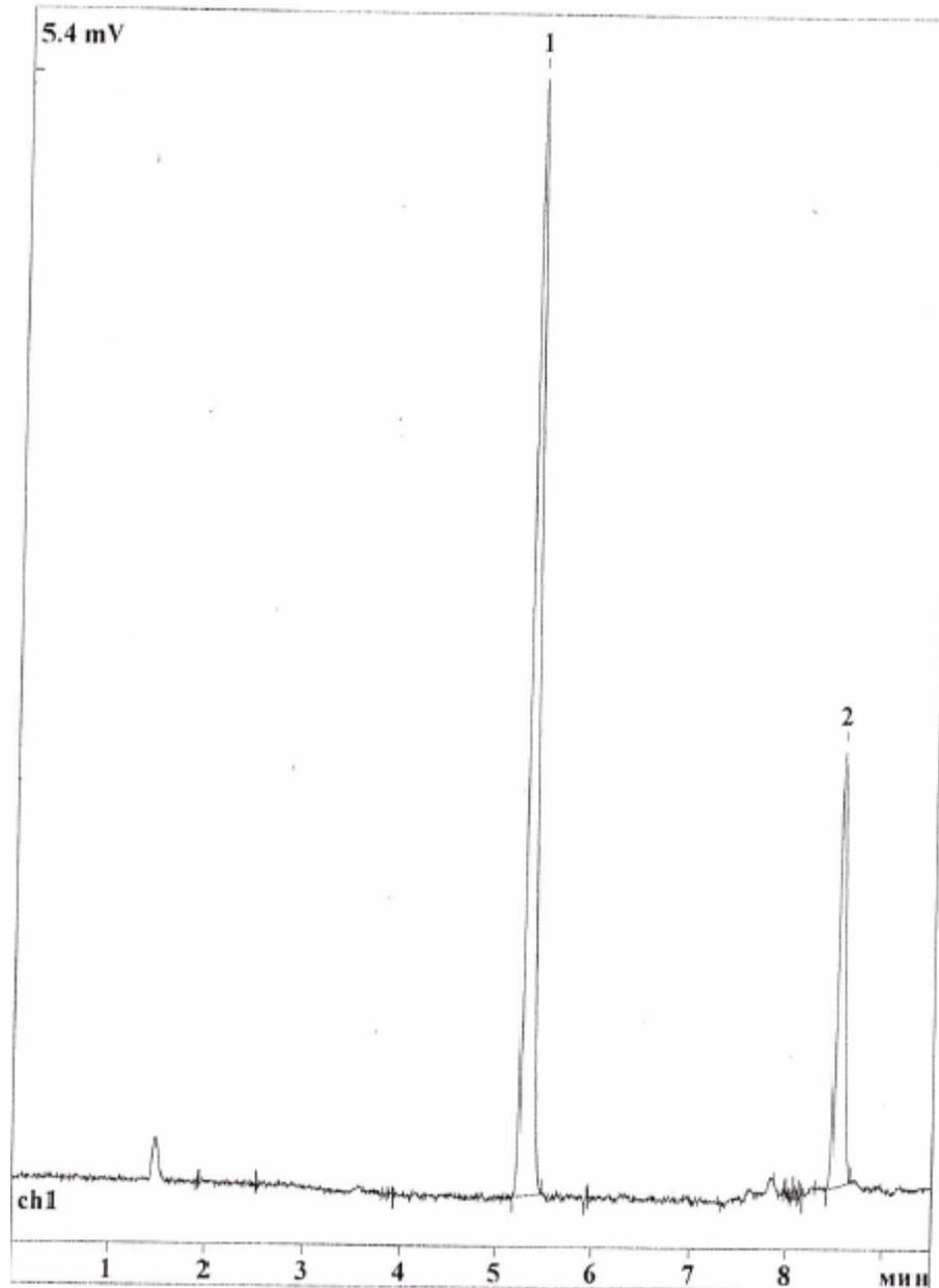
**Рисунок 9.** Типичная ГЖХ-хроматограмма раствора для проверки пригодности хроматографической системы (1-этилацетат; 2- бутилацетат)
