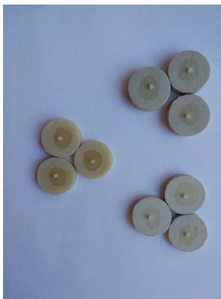
Рисунок 5. Образцы для проведения измерения силы адгезии
