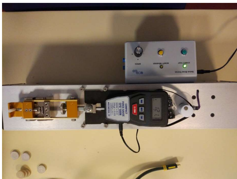
Рисунок 7. Аппарат для измерения прочности при сдвиге Shear Bond Tester фирмы «Bisco»
