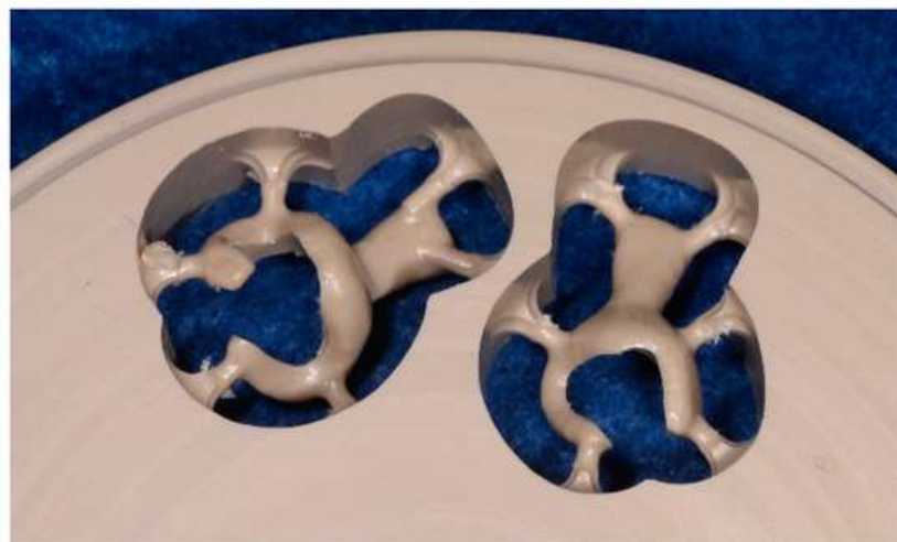
Рисунок 49. Кламмеры из ПЭЭК, полученные методом фрезерования
