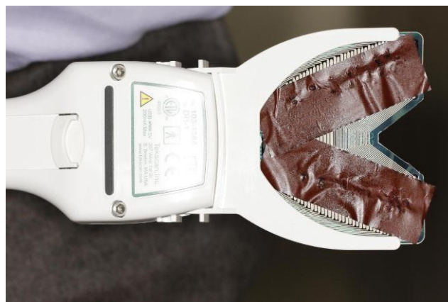
Рисунок 2-21 - Модификация сенсора Т-скана с использованием копировальной бумаги
