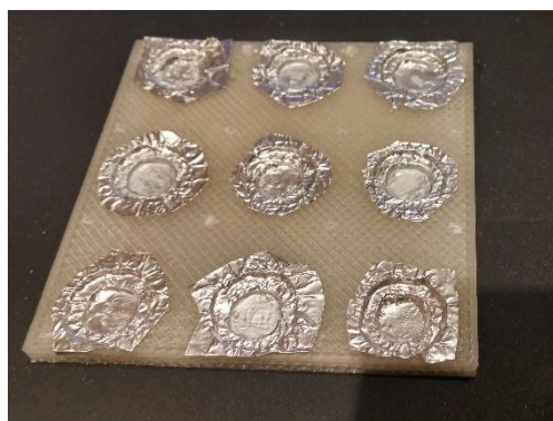
Рисунок 8. Форма для отливки имплантатов
