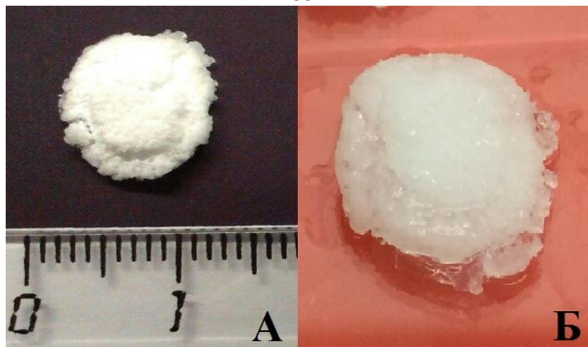
Рисунок 18. Внешний вид матриксов из ПОБ: А – до и Б – после насыщения альгинатом
