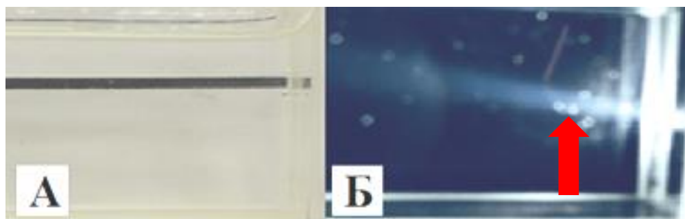
Рис. 19. Наблюдение эффекта Фарадея-Тиндаля в водном растворе (Нифедипин-ПЭГ-400 1:3 по массе):
