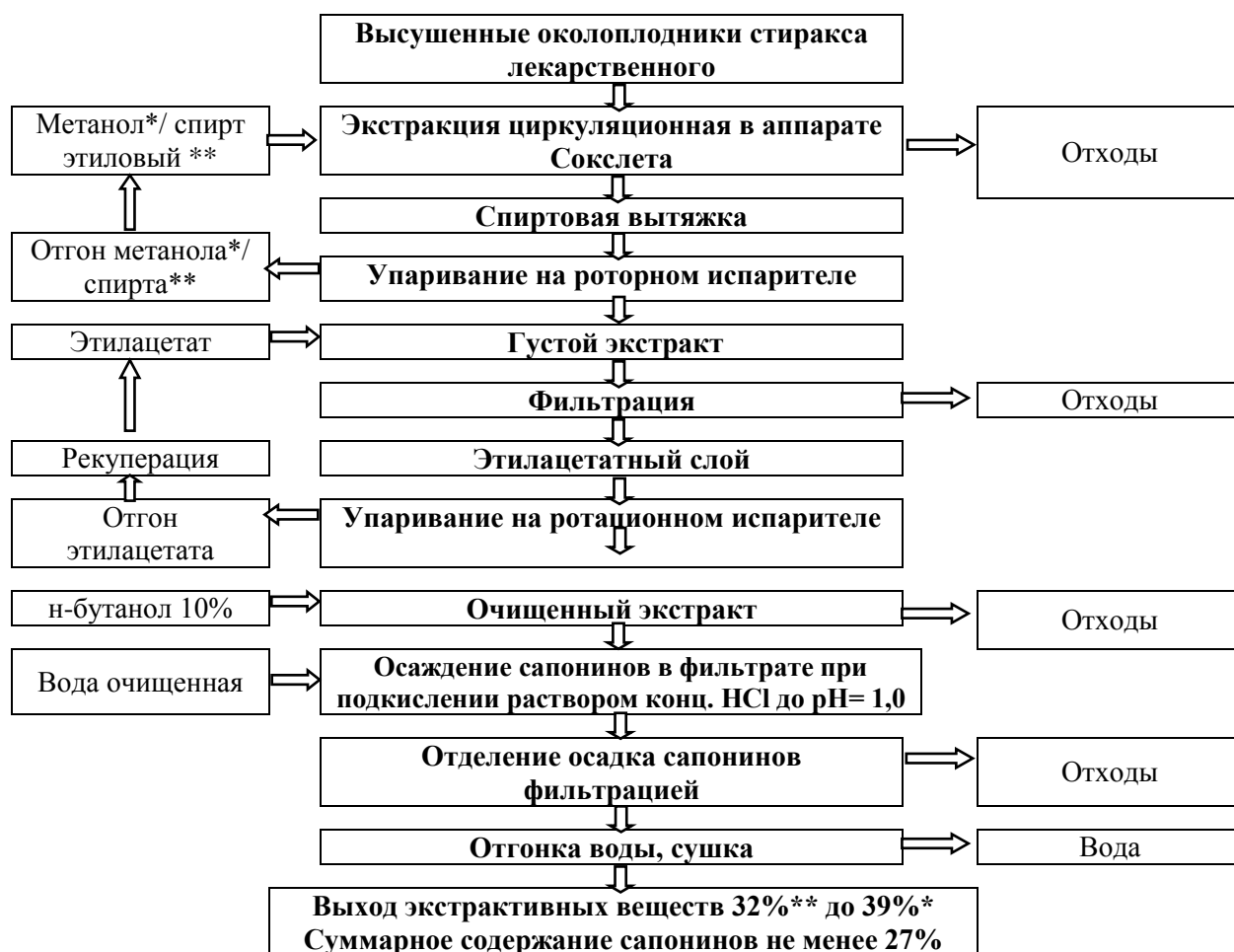
Рисунок 6. Технологическая схема выделения сапонинов из высушенных околоплодников стиракса лекарственного
