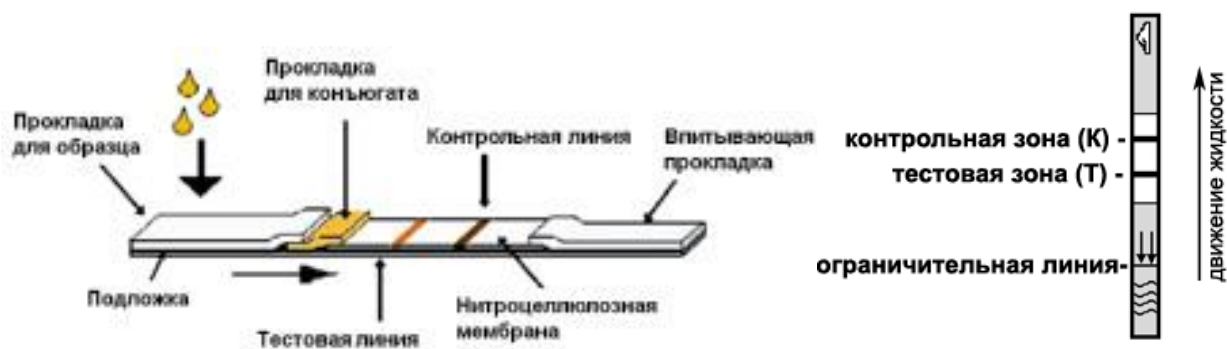
Рисунок 9 – Схематическое изображение иммунохроматографической тест-полоски
