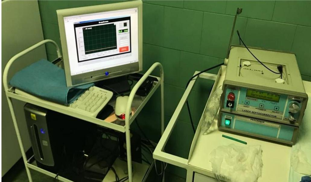
Рисунок 7. Эрбиевый волоконный лазер
