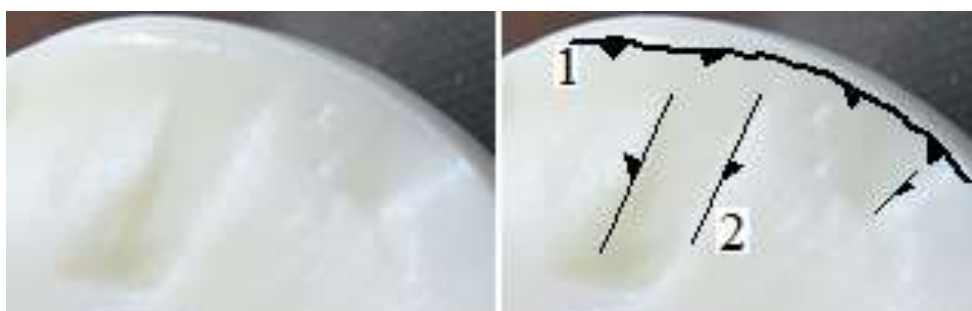
Рисунок 91 – Гребни отрыва (1) и продольные гребни сдвига (2) на поверхности экспериментального местного основного разрыва
