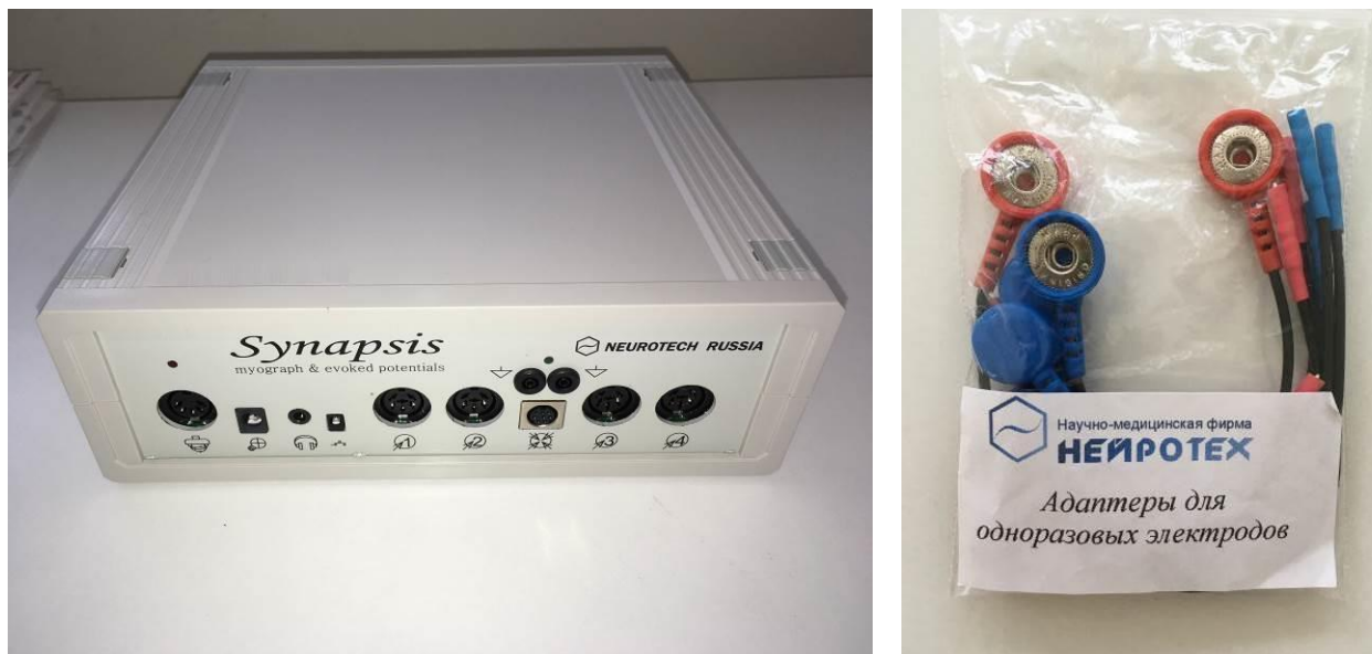
Рис. 2.6. Нейромиоанализатор Синапсис. Внешний вид прибора и адаптеры к электродам (увеличение)
