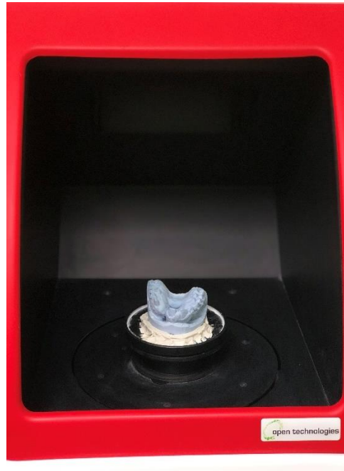
Рисунок 6. Сканирование модели зубов верхней челюсти в 3D сканере Open Technologies.
