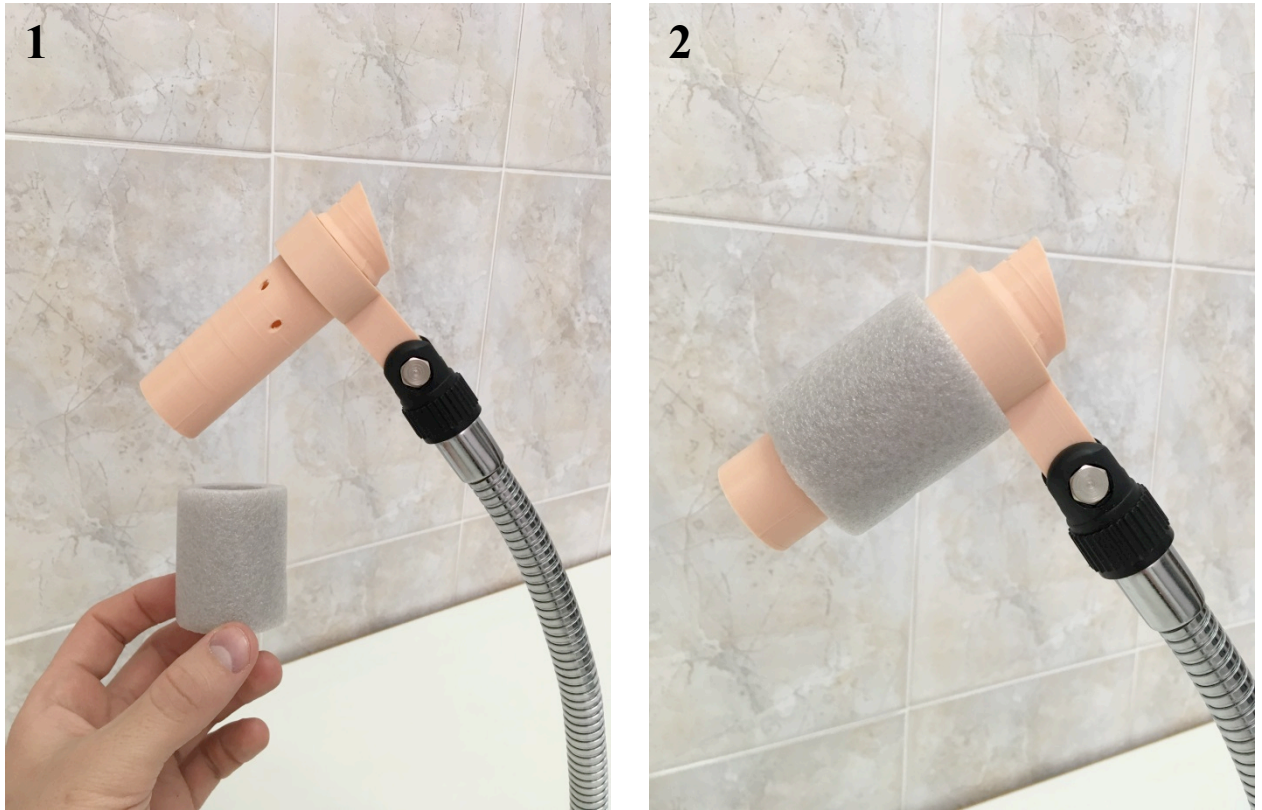
Рисунок 45. Иллюстрация установки манжеты из пенополиэтилена на модель полости носа №4: 1 – модель, введенная в фиксатор, и манжета (вид сбоку); 2 – манжета, установленная на модель (вид сбоку).
