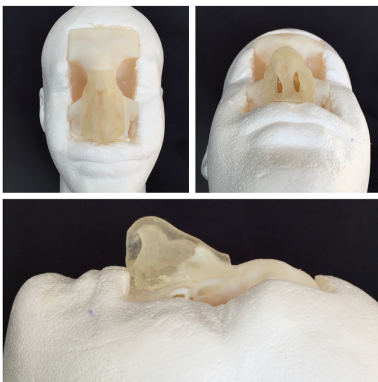
Рисунок 30. Иллюстрация внешнего вида 3D-модели остиомеатального комплекса и лобной пазухи, установленной в голову манекена из пенопласта.
