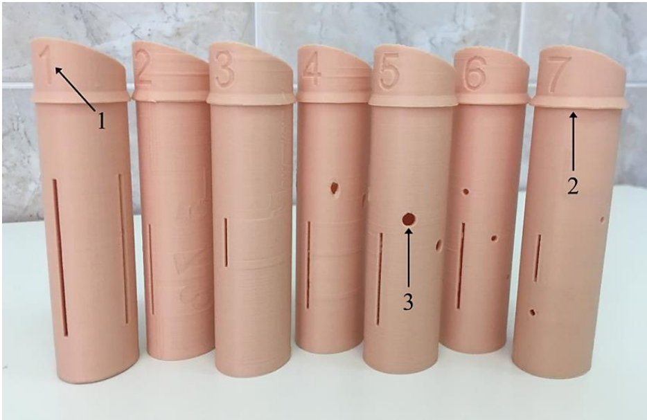
Рисунок 34. Цилиндры, применяемые в качестве моделей полости носа: 1 – номер цилиндра; 2 – ограничитель; 3 – элемент для манипулирования.
