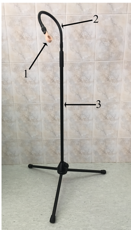
Рисунок 37. Напольное устройство фиксации: 1 – фиксатор модели полости носа; 2 – гибкая штанга «гусиная шея»; 3 – напольная стойка.
