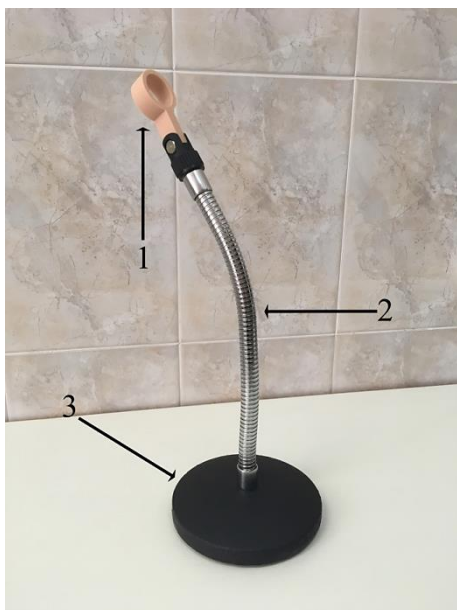
Рисунок 36. Настольное устройство фиксации: 1 – фиксатор модели полости носа; 2 – гибкая штанга «гусиная шея»; 3 – настольная платформа.
