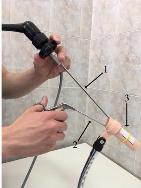
Рисунок 35. Иллюстрация введения эндоскопа и медицинского инструмента в модель полости носа: 1 – эндоскоп; 2 – медицинский инструмент; 3 – модель.
