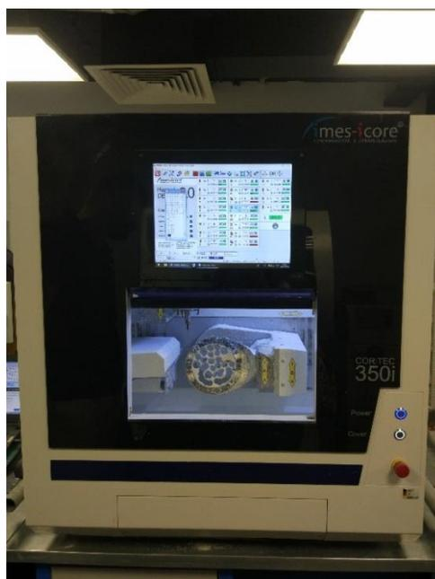
Рисунок 3. Процесс фрезерования протеза на станке «Coritec 350i» («Imes-icore», Германия)
