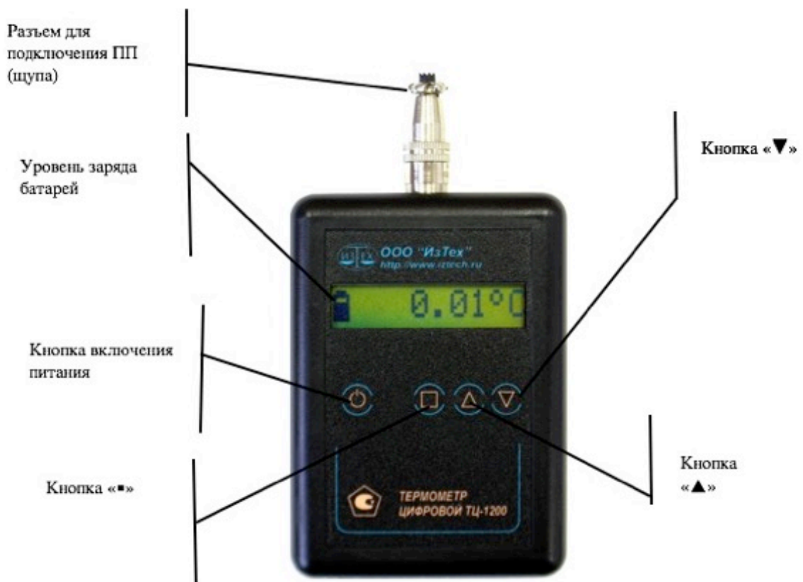
Рис. 11. Конструкция прибора ТЦ-1200
