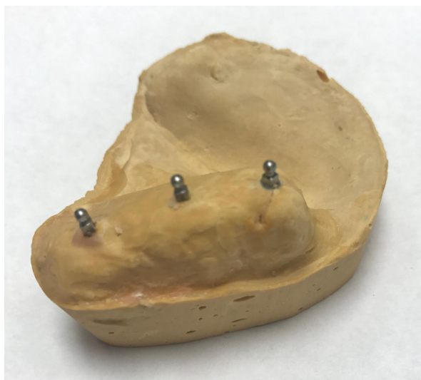
Рисунок 2а – Гипсовая модель с аналогами дентальных мини-имплантатов для проведения эксперимента
