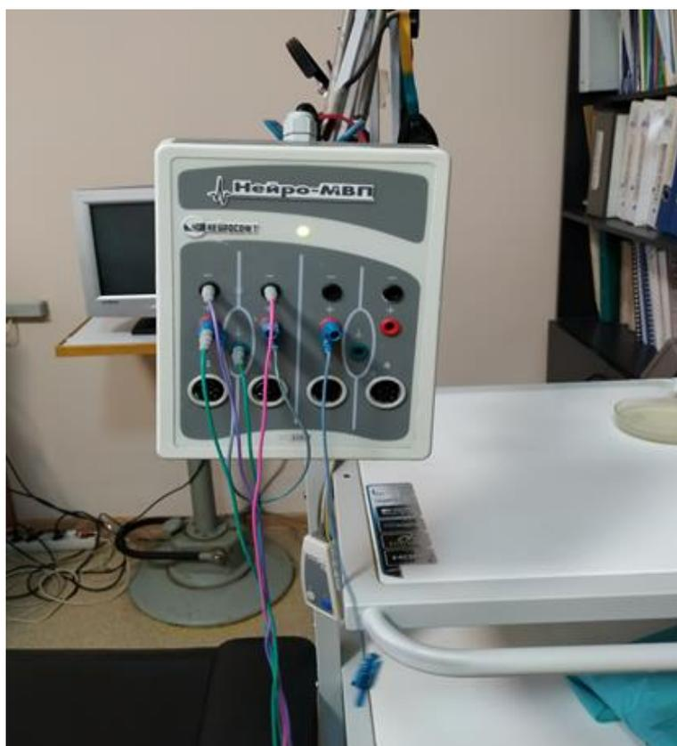
Рисунок 16 – Аппарат Нейро-МВП для исследования АСВП и ТВП.
