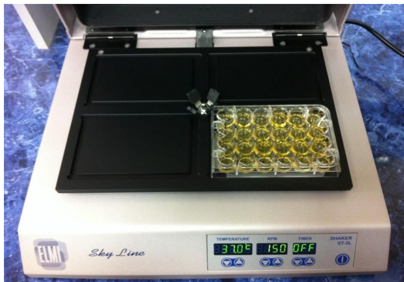
Рис. 13. Шейкер-термостат с фиксированной пластиковой кассетой для культивирования биопленок аэробов в условиях текучей среды
