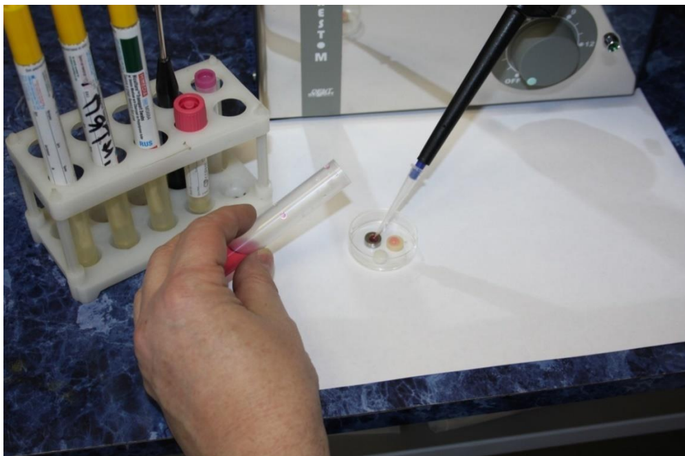
Рис. 30. Нанесение взвеси тест-штамма S. sanguinis на образцы стоматологических материалов (диоксид циркония, метилметакрилат, полиакрил «Фторакс») для исследования первичной адгезии
