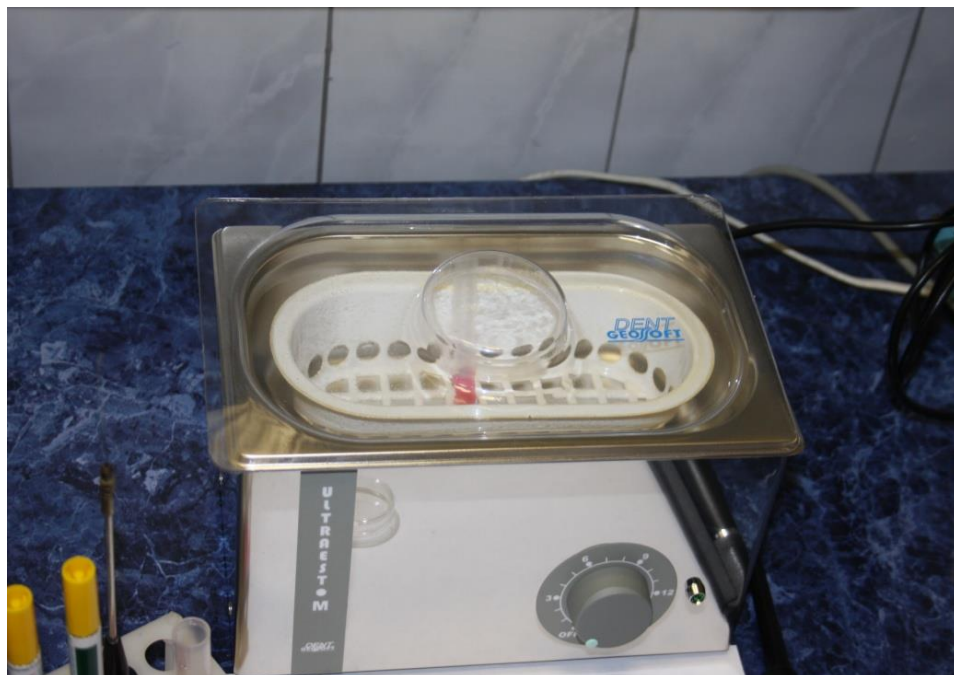
Рис. 3. Обработка образца стоматологической пластмассы с тест-культурой в ультразвуковой ванночке UltraEst-M («Геософт», РФ)
