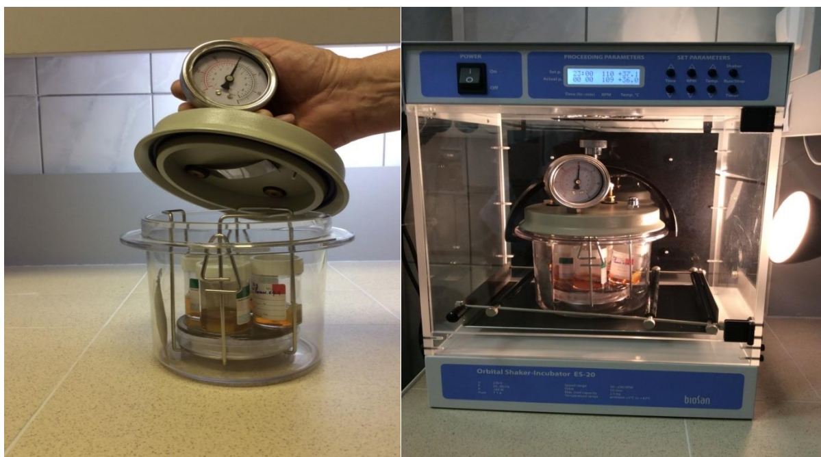
Рис. 12. Шейкер-инкубатор с установленным анаэроостатом для культивирования биопленок анаэробов в условиях текучей среды
