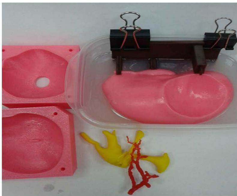
Рис. 4.3.3. Изготовленные силиконовой формы для отливания 3D модели, и заливка формы.
