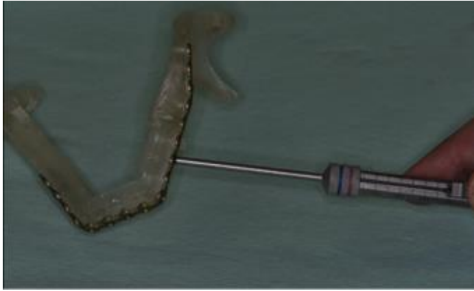
Рисунок 9 – Измерение глубины отверстий для фиксирующих винтов на пластиковой модели
