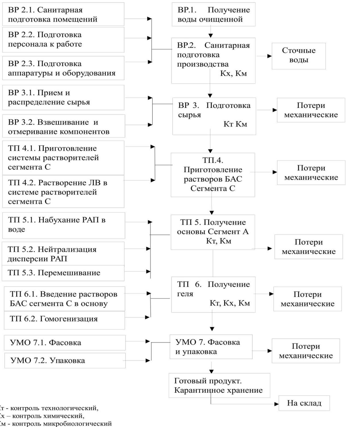
*Рисунок 6. 8 Принципиальная технологическая схема получения гелей неполярных ФС (ИДН 0,5% и Лоратадина 1%) на основе РАП*
