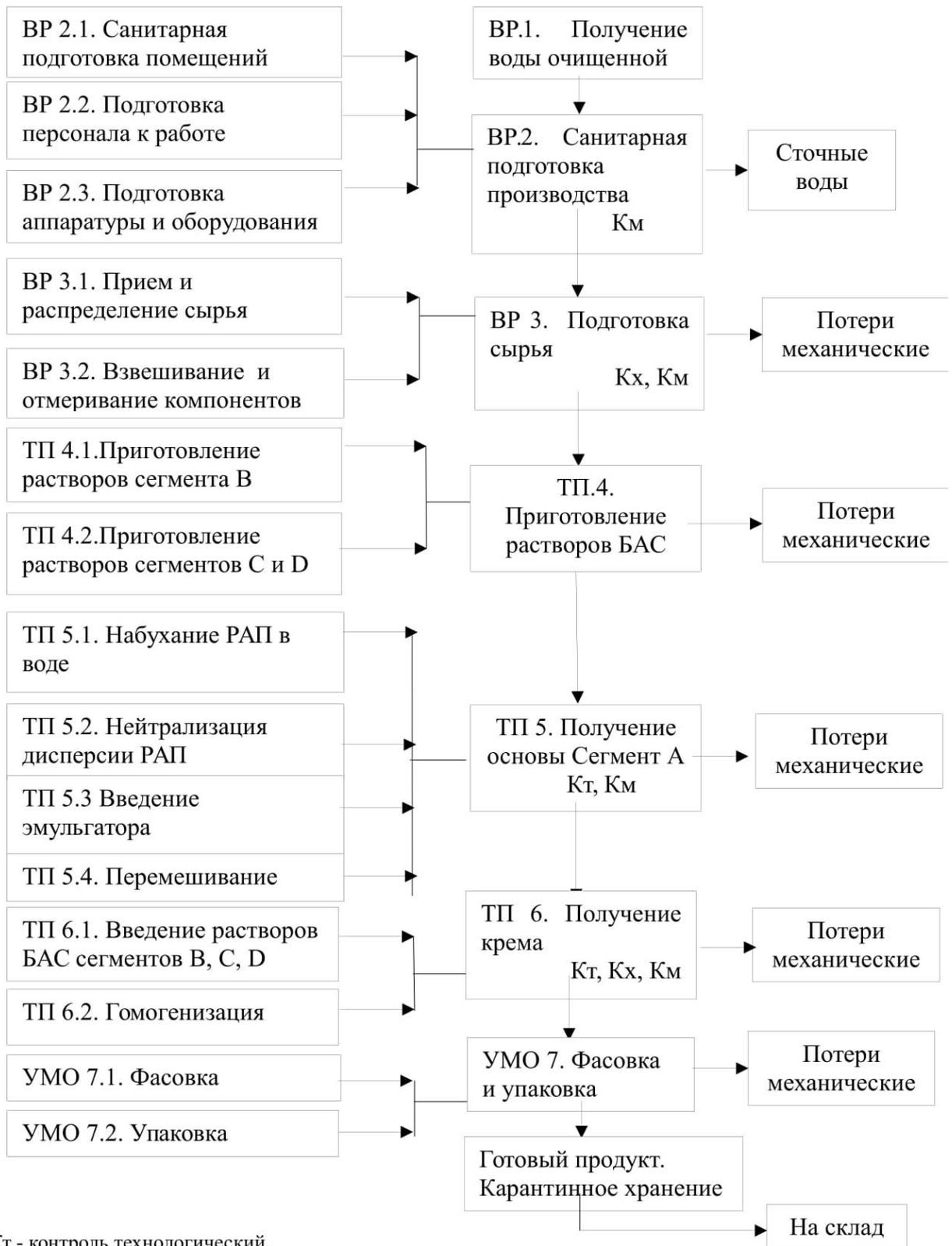
*Рисунок 5. 5 Принципиальная технологическая схема получения эмульсионных систем с неполярными комплексами аргании, калины, граната и красной смородины на основе полярной матрицы.*
