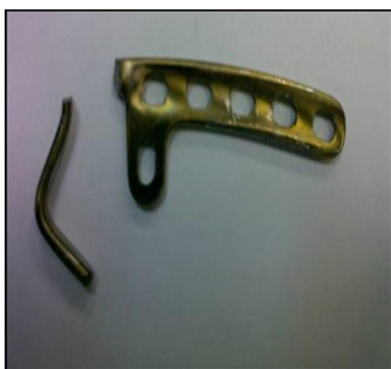
Рис. 3.2. Крючковидная пластина. Перелом фиксатора
