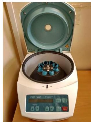
Рисунок 2.7 – Лабораторная центрифуга «EBA-200» («Hettich-Zentrifugen», Германия)
