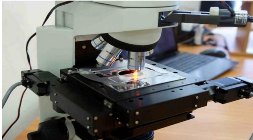
Рисунок 6. Внешний вид Раман - флюоресцентного микроскопа со сканирующей насадкой (слева) на базе АПК ИнСпектр М
