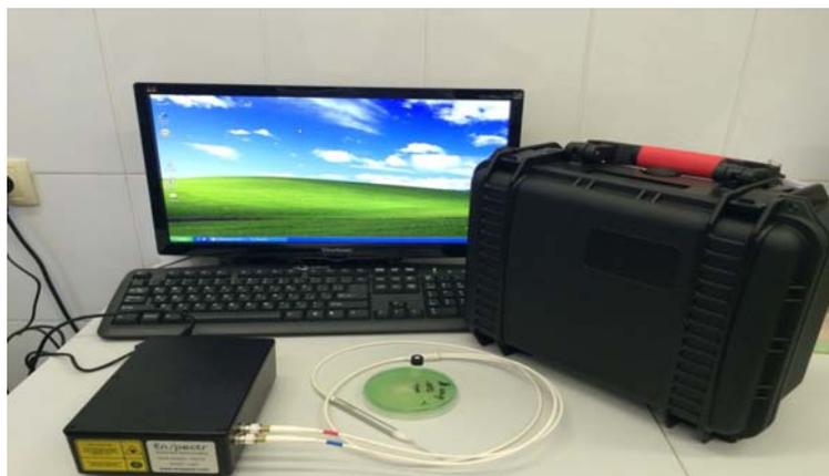
Рисунок 1. АПК «ИнСпектр М» с оптико-волоконным световодным датчиком
