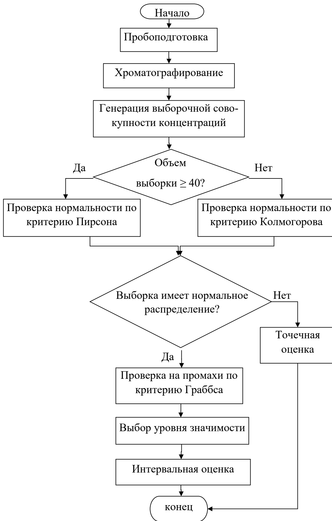
Рисунок 1. Алгоритм количественного определения эндогенных веществ в биологических объектах хроматографическим методом
