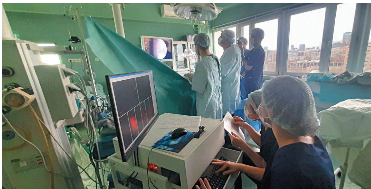
Тестовое измерение хрящевой ткани коленного сустава в ходе операционного вмешательства с помощью метода спектроскопии диффузного отражения света
