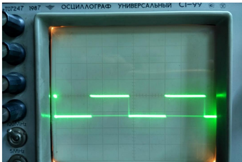
Рисунок 13 – Прямоугольные импульсы постоянного тока отрицательной полярности
