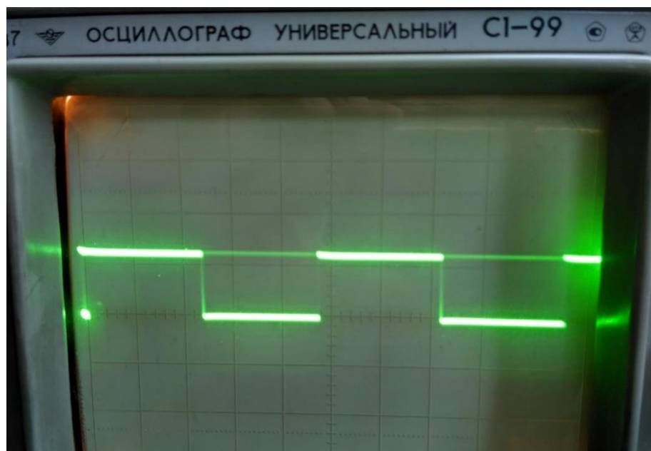
Рисунок 12 – Прямоугольные импульсы постоянного тока положительной полярности
