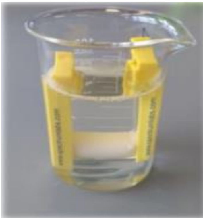
Рисунок 4.2 – Стакан с диализным мешком для испытания
