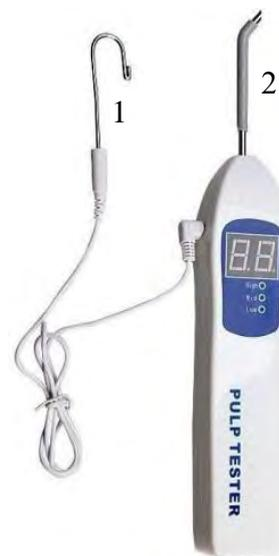
Рис. 12 Тестер пульпы: 1-электрод из нержавеющей стали, прикрепляется за уголок рта пациента; 2 – измерительный зонд (активный электрод), которым прикасаются к поверхности зуба.
