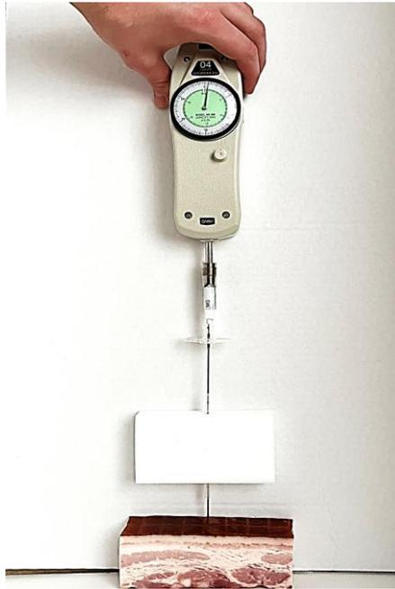
Рисунок 30 – Измерение силы пункции на свиной коже
