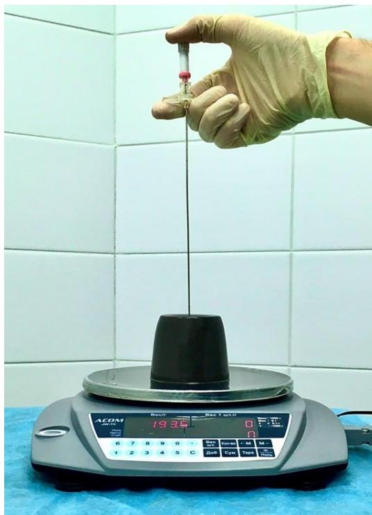
Рисунок 28 – Измерение силы пункции полипропиленового макета
