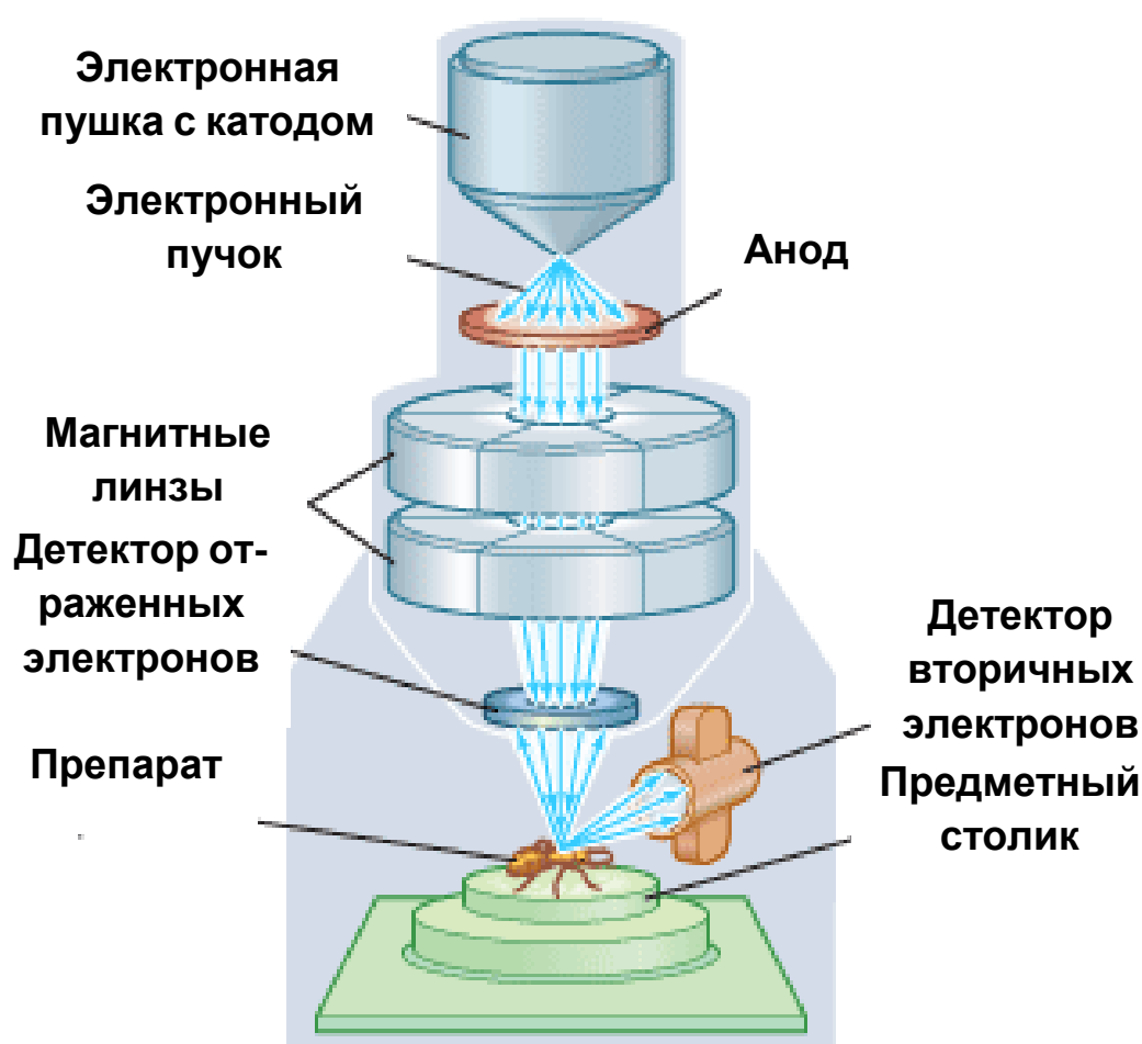
Рисунок 14 - Схема работы сканирующего электронного микроскопа
