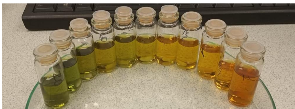
Рисунок 18 – Калибровочные растворы для определения ПВС: справа налево концентрация ПВС увеличивается, оранжевая окраска раствора I_2 в KI сменяется зеленой в результате образования комплекса синего цвета ПВС с I_2 в KI в присутствии борной кислоты с длиной волны поглощения 673 нм
