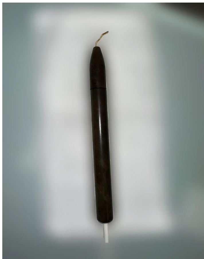
Рисунок 5– Электрододержатель со вставленным золотым электродом
