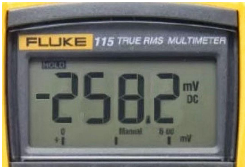
Рисунок 9 – Электрохимический потенциал исследуемой металлической конструкции
