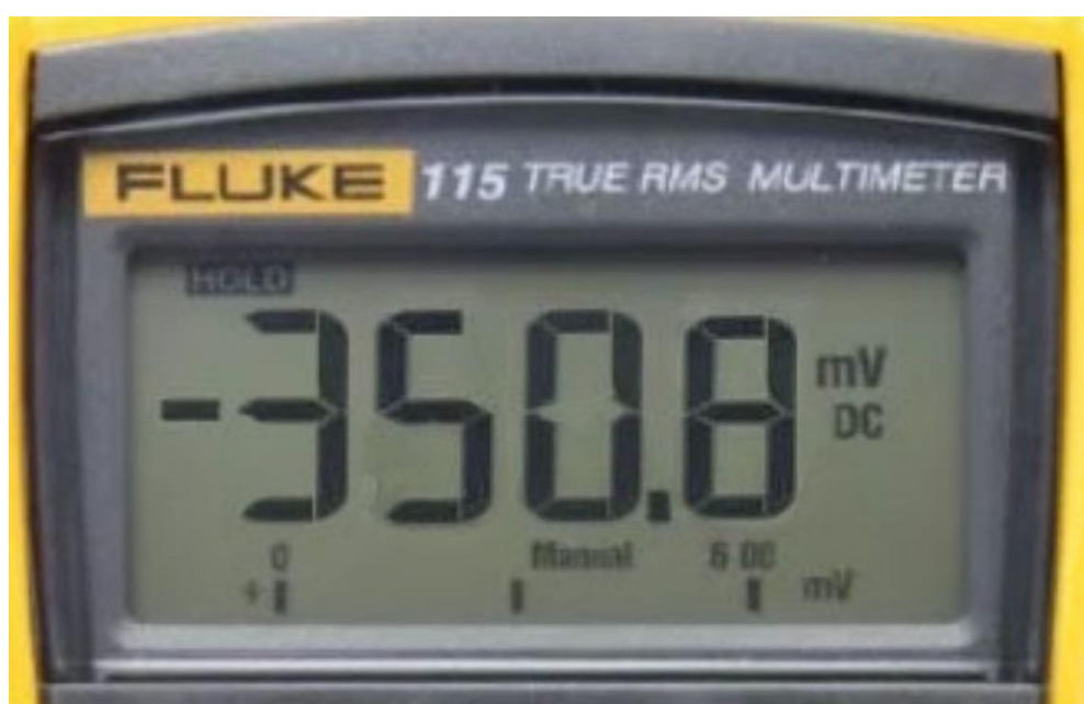
Рисунок 10 – Показание милливольтмера при измерении потенциалов двух металлических конструкций (А, Б)
