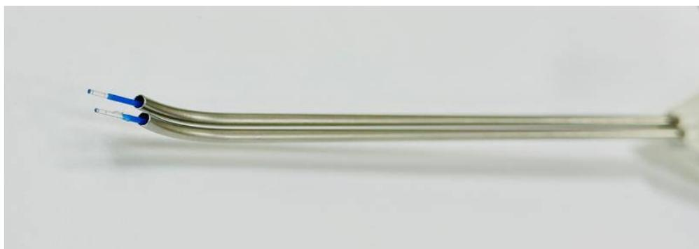
Рисунок 31 – Оптические волокна в составе приемо-передающего зонда
