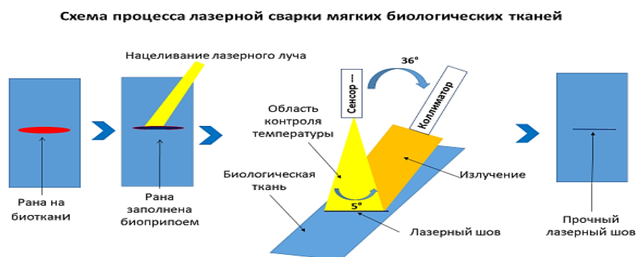
Рисунок 5 – Схема лазерной сварки биологических тканей с помощью биоприпоя и лазерного аппарата с длиной волны 970 нм
