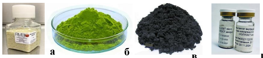
Рисунок 4 – Компоненты биоприпоя для лазерной сварки тканей: а) бычий сывороточный альбумин (БСА), б) индоцианин зеленый (ИЦЗ), одностенные углеродные нанотрубки (ОУНТ), коллаген I типа (КIт)
