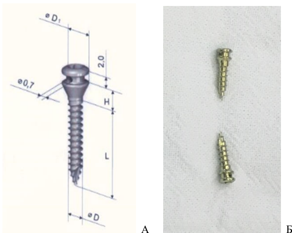
Рисунок 13 – Ортодонтические имплантаты «Конмет»: схематическое изображение (А) и фото (Б)
