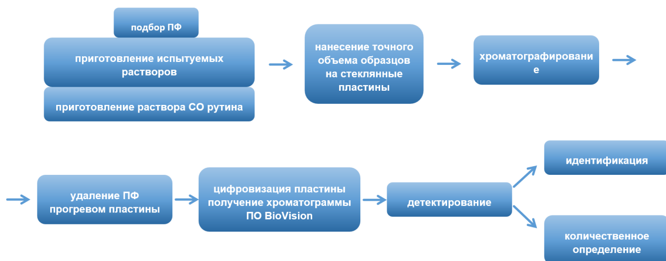
Рисунок 1 – Этапы хроматографирования методом ВЭТСХ
