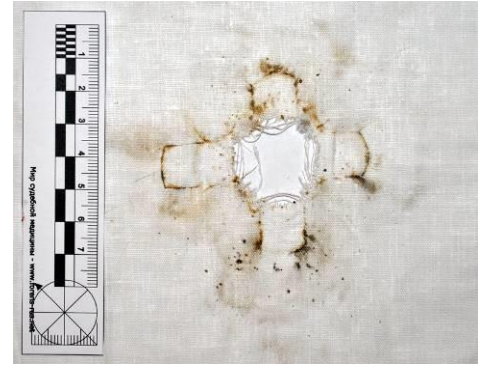
Рисунок 3.2.32 – Вид повреждения и отложения копоти при выстреле с расстояния 40,0 см по ткани с подложкой из ДСП
