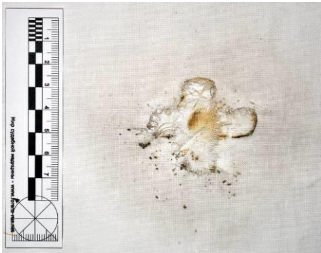
Рисунок 3.2.7 – Вид повреждения и отложения копоти при выстреле с расстояния 30,0 см по ткани без подложки
