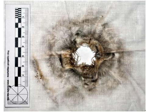
Рисунок 3.2.28 – Вид повреждения и отложения копоти при выстреле с расстояния 5,0 см по ткани с подложкой из ДСП
