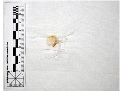
Рисунок 3.2.12 – Вид повреждения в виде отпечатка пули при выстреле с расстояния 300,0 см по ткани без подложки
