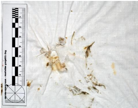
Рисунок 3.2.35 – Вид повреждения и отложения копоти при выстреле с расстояния 200,0 см по ткани с подложкой из ДСП
