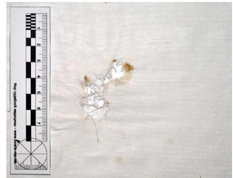
Рисунок 3.2.24 – Вид повреждения в виде отпечатка пули при выстреле с расстояния 300,0 см по ткани с подложкой из ДВП
