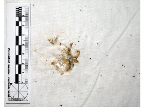
Рисунок 3.2.22 – Вид повреждения и отложения копоти при выстреле с расстояния 100,0 см по ткани с подложкой из ДВП
