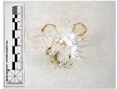
Рисунок 3.2.8 – Вид повреждения и отложения копоти при выстреле с расстояния 40,0 см по ткани без подложки
