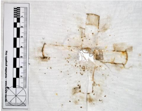
Рисунок 3.2.21 – Вид повреждения и отложения копоти при выстреле с расстояния 50,0 см по ткани с подложкой из ДВП
