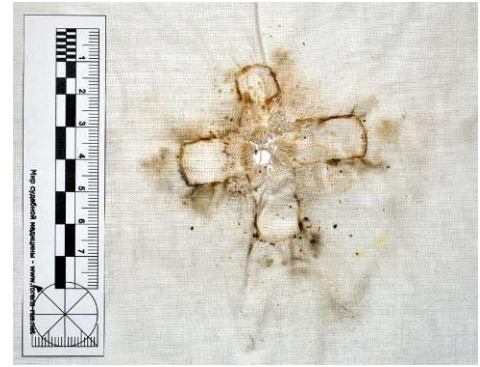
Рисунок 3.2.20 – Вид повреждения и отложения копоти при выстреле с расстояния 40,0 см по ткани с подложкой из ДВП
