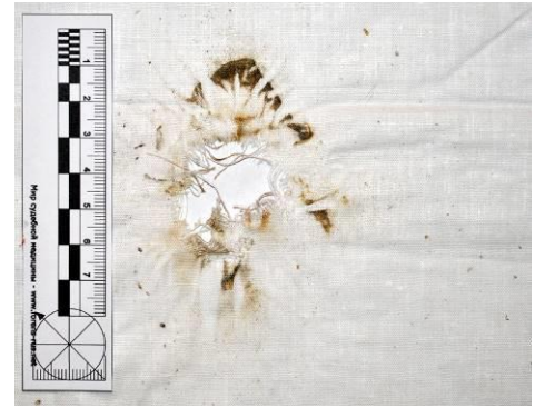
Рисунок 3.2.34 – Вид повреждения и отложения копоти при выстреле с расстояния 100,0 см по ткани с подложкой из ДСП
