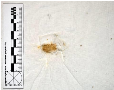
Рисунок 3.2.23 – Вид повреждения в виде отпечатка пули при выстреле с расстояния 200,0 см по ткани с подложкой из ДВП
