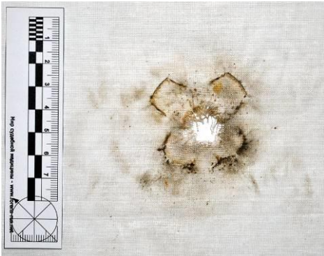
Рисунок 3.2.19 – Вид повреждения и отложения копоти при выстреле с расстояния 30,0 см по ткани с подложкой из ДВП
