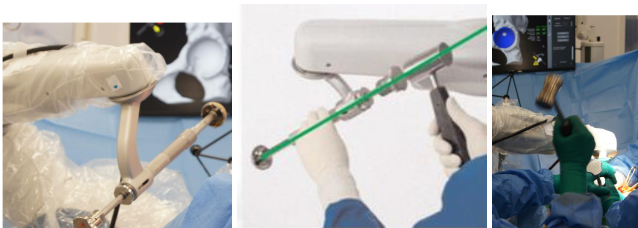
Рисунок 49 – Ограничитель манипулятора роботизированной системы во время импакции
