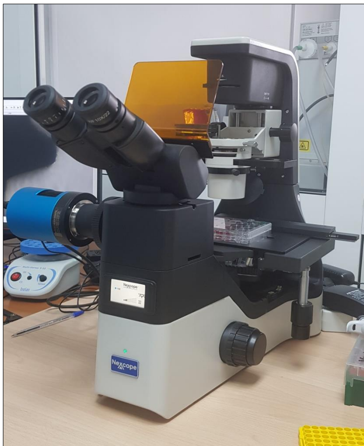
Рисунок 4 – Инвертированный люминесцентный биологический микроскоп Nexcore NIB630FL (Novel Optics, Китай)
