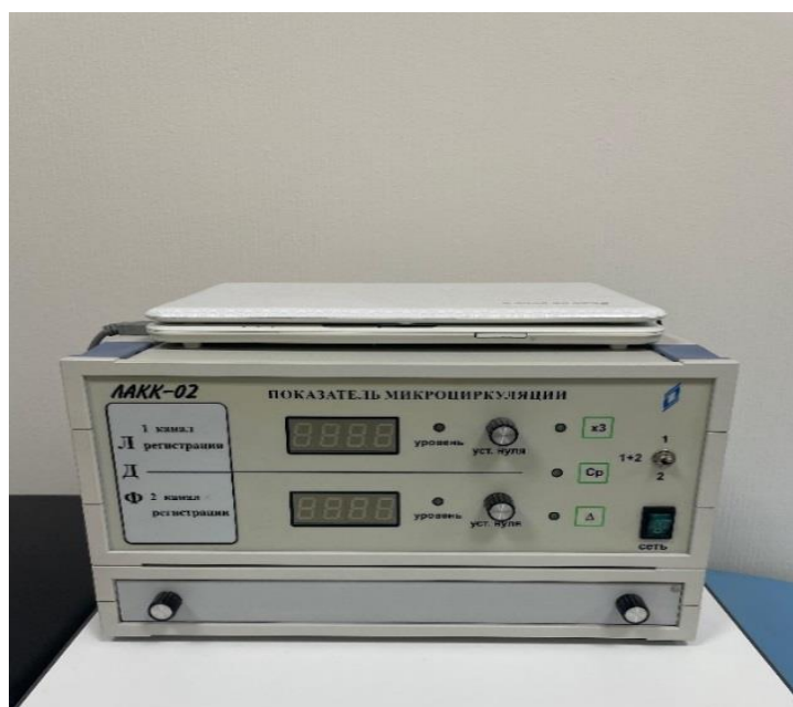
Рисунок 15 – Аппарат «ЛАКК-02» (производство — Россия), предназначенный для проведения лазерной доплеровской флоуметрии
