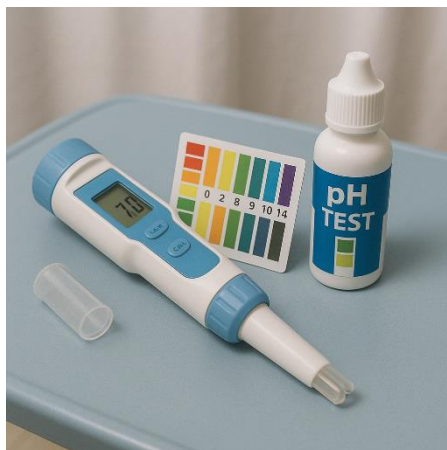
Рисунок 17 – Инструменты для измерения pH слезной жидкости: электронный pH-метр, индикаторные тест-полоски и раствор для калибровки
