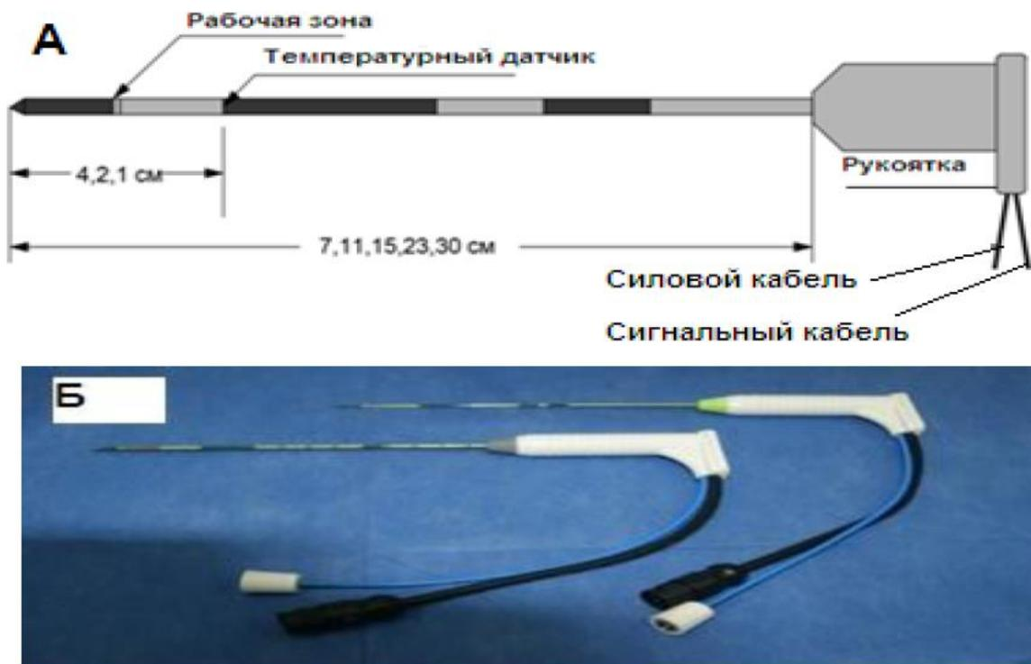
Рисунок 6 – Абляционные антенны: А – схема устройства; Б – внешний вид
